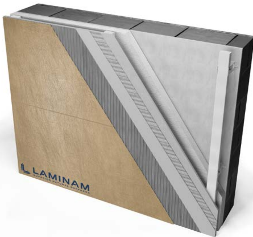
Esempio di pannello in fibrocemento applicato come controparete.
