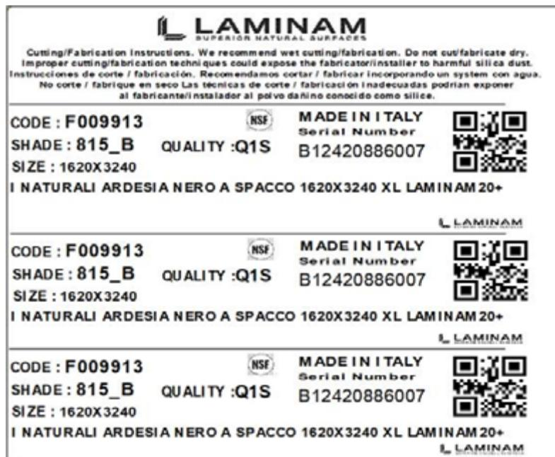
Per agevolare il riconoscimento delle lastre durante lo stoccaggio a magazzino, su uno dei lati corti della lastra sono riportati in costa i seguenti riferimenti: codice art., tono, scelta, N° seriale (solo per scelta Q1) e descrizione dell'articolo.
