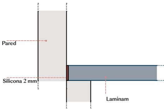
Proteja la superficie adyacente a la aplicación de la silicona con una película de plástico o con cinta adhesiva de goma. Si la encimera está compuesta por varias piezas, acerque las piezas con cuidado para evitar impactos en los bordes expuestos. Para facilitar esta operación, se pueden interponer calzos que se quitarán una vez que estén colocadas las tablas. Una las dos piezas con productos de silicona o colas transparentes o de color, y elimine los restos después de la aplicación.
