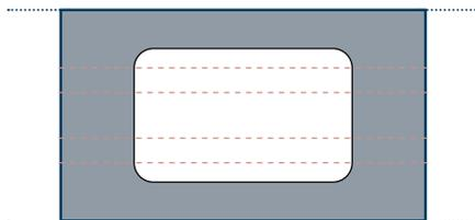
Si el mueble bajo tiene cajones deslizantes, dichos soportes deberán tener la forma adecuada para permitir que los cajones se puedan deslizar.
