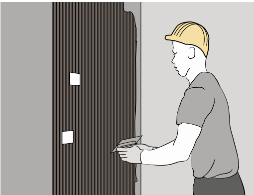
Auftrag des Klebstoffs auf den Putz
