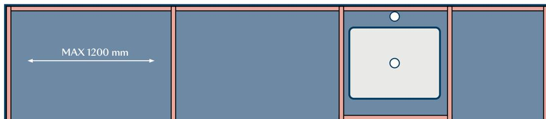
Si les bases d'appui sont très éloignées ou que, pour des raisons de dimensions, logistiques, etc., une plus grande résistance est nécessaire, le transformateur peut décider d'appliquer des renforts sous le plan de travail.
